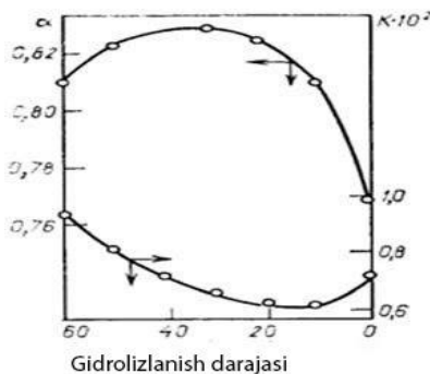
4- rasm. K va a koeffitsiyentlarni poliakrilamidning gidrolizlanish darajasiga (GD) bog'liqligi (25 °C).
