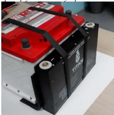
Рис.3. Пример установки суперконденсатора
