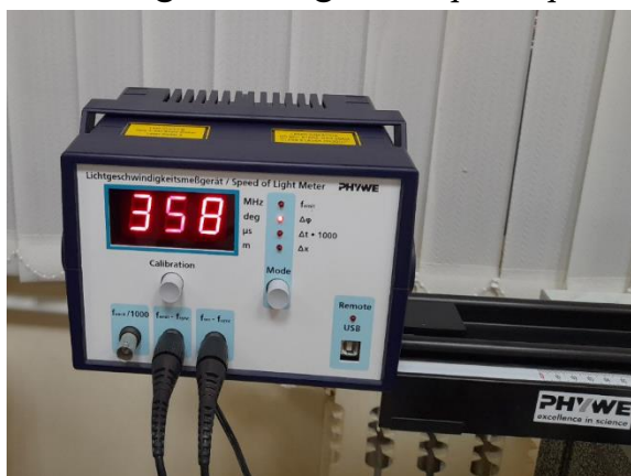
2-rasm. Retroreflektorli yorug'lik tezligini raqamli o'lchash qurilmasi.
